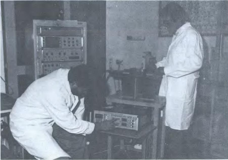
由一名学员设计并由 PCL 实验室仪器股组装的以微处理机为基础的土壤样品密度测量所用控制器设备。
