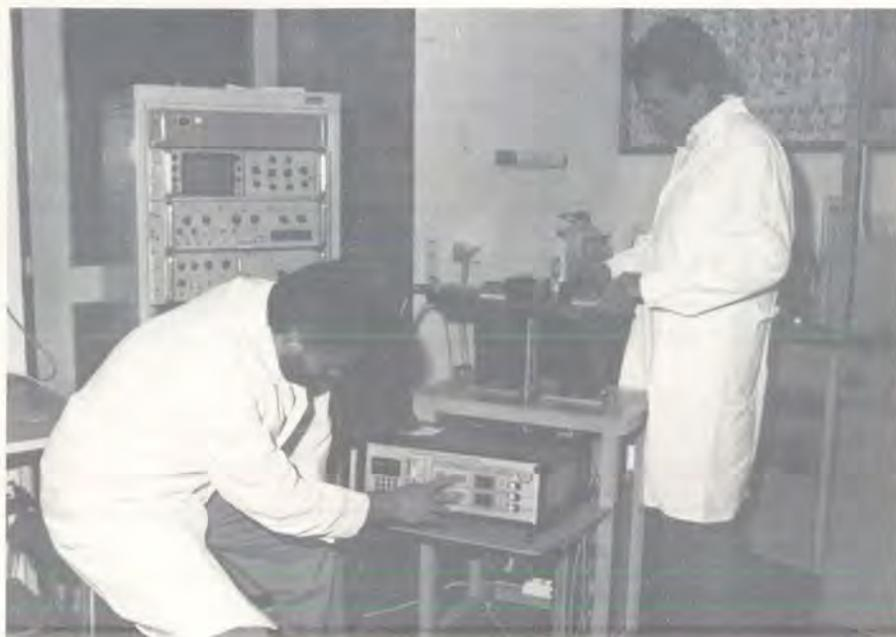
Микропроцессорное контрольное устройство для измерения плотности образца почвы, разработанное стажером и выполненное Группой приборов Лаборатории физико-химических приборов
