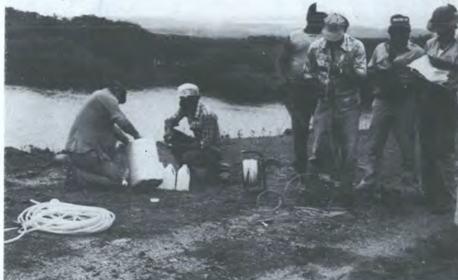
在多米尼加共和国的 马古瓦卡水库调查坝的渗 漏情况。
