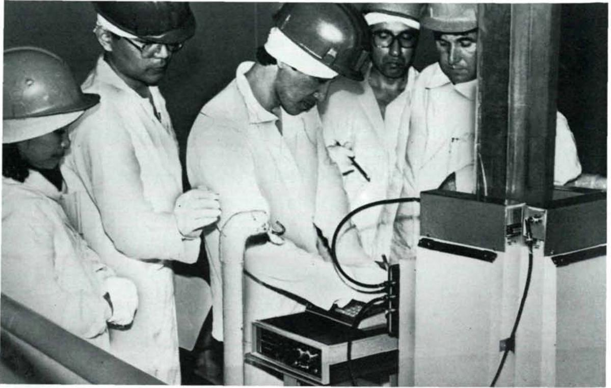
▲ Durante una inspección en la URSS, funcionarios del OIEA y nuevos inspectores miden el contenido de uranio de un conjunto combustible VVER-400 nuevo utilizando un collar de coincidencias neutrónicas para el uranio. (Cortesía del Comité Estatal para la Utilización de la Energía Atómica de la URSS).
