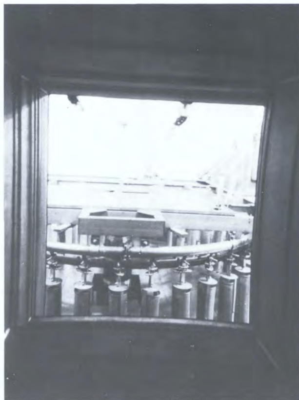
В помещении для облучения куколки для их стерилизации подвергаются воздействию гамма-излучения от источника кобальт-60 в течение 10 минут
