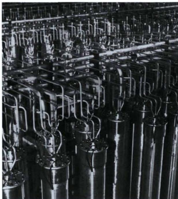
Centrifugeuse à plusieurs étages de l'usine pilote japonaise d'enrichissement de l'uranium. (Photo: Japan AEC)
