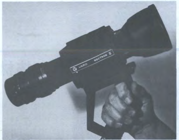
用于辐照燃料元件识别和衡算的改进型切伦柯夫观测装置。
