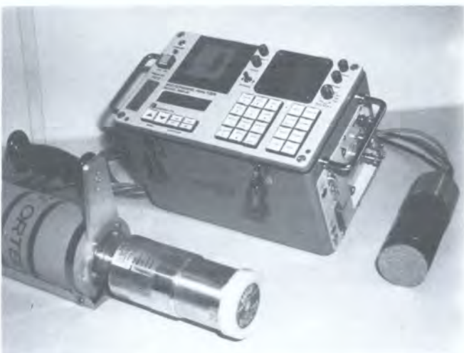
„Рабочая лошадка“ инспектора для гамма-спектрометрических измерений — переносной прибор мини-МСА
