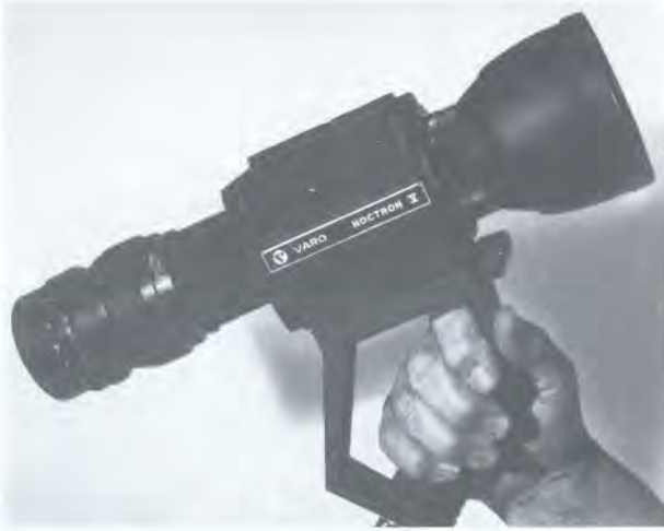
Усовершенствованный прибор наблюдения излучения Черенкова, который используется для идентификации и учета облученных топливных элементов
