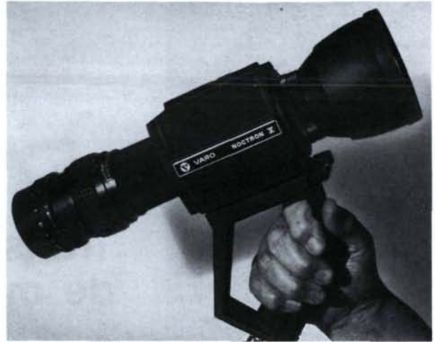
Nouveau modèle de lunette d'observation de l'effet Cerenkov utilisée pour identifier et comptabiliser les éléments combustibles irradiés.
