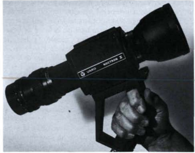
El dispositivo de observación del brillo de Cherenkov, perfeccionado, que se emplea para identificar y contabilizar los elementos combustibles irradiados.
