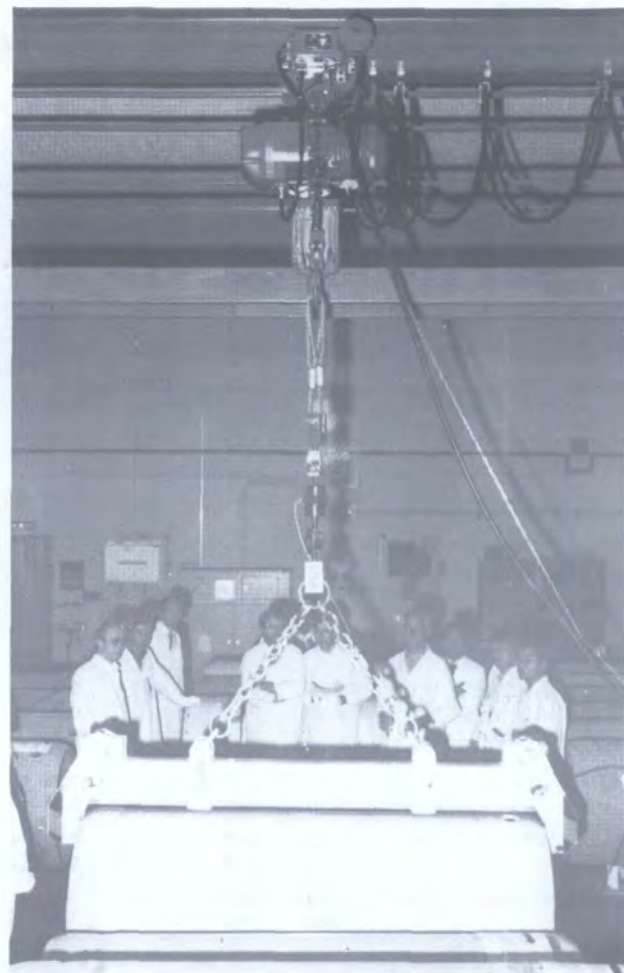
正在利用以负荷传感器为基础的称量系统核对六氟化铀钢瓶重量(约3吨)。
