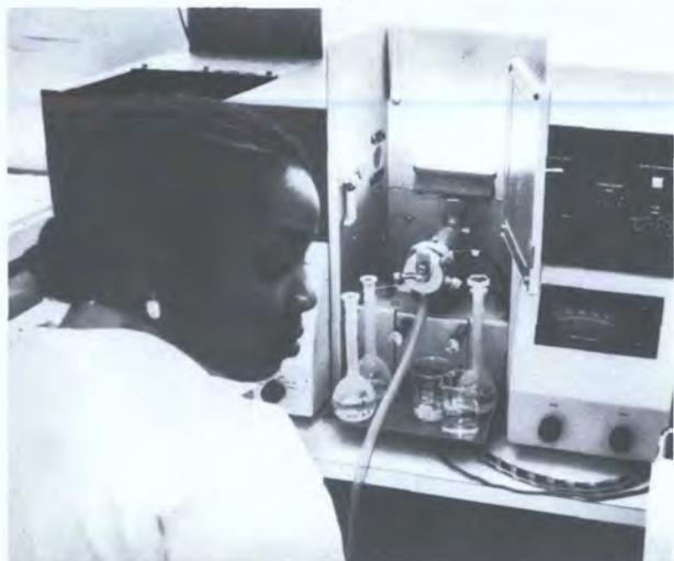
测定雨水样品重金属污染的试验
