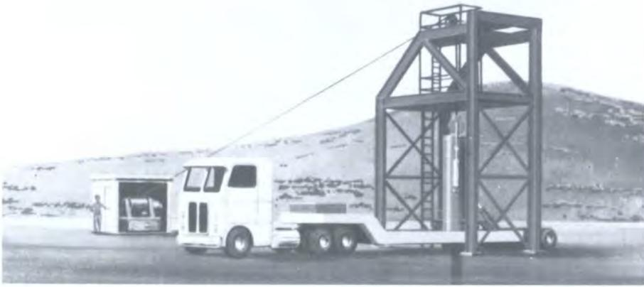
Частью программы США по обращению с радиоактивными отходами стало проведение эксперимента с отработавшим топливом „Климакс“, цель которого заключалась в оценке воздействия отработавшего топлива, помещенного в формации кристаллических твердых пород на глубине 1400 футов на Невадском испытательном полигоне. Транспортные средства доставили упаковки с отходами к вертикальной скважине, пробуренной в туннеле, пробуренном в граните (Источник: US DOE, AIF).
