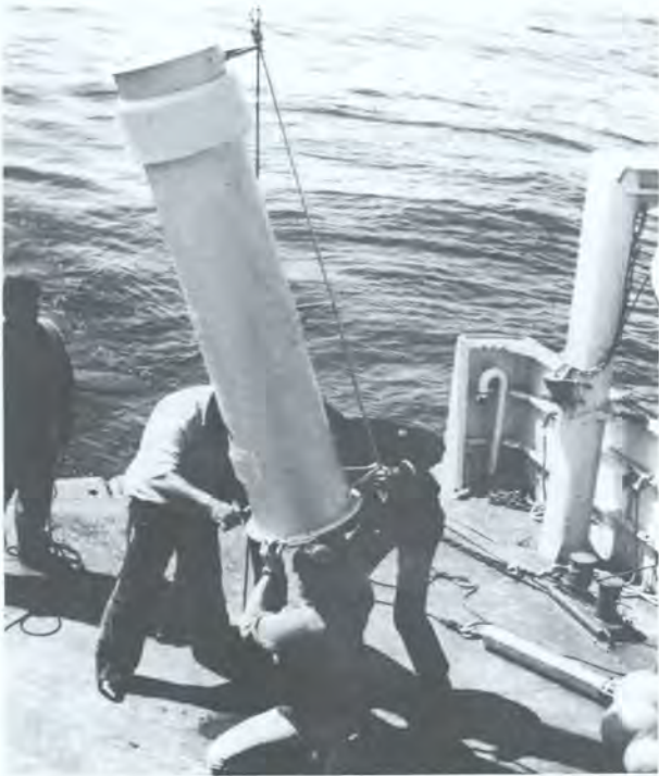
在船上准备往下放置沉积物收集器。
