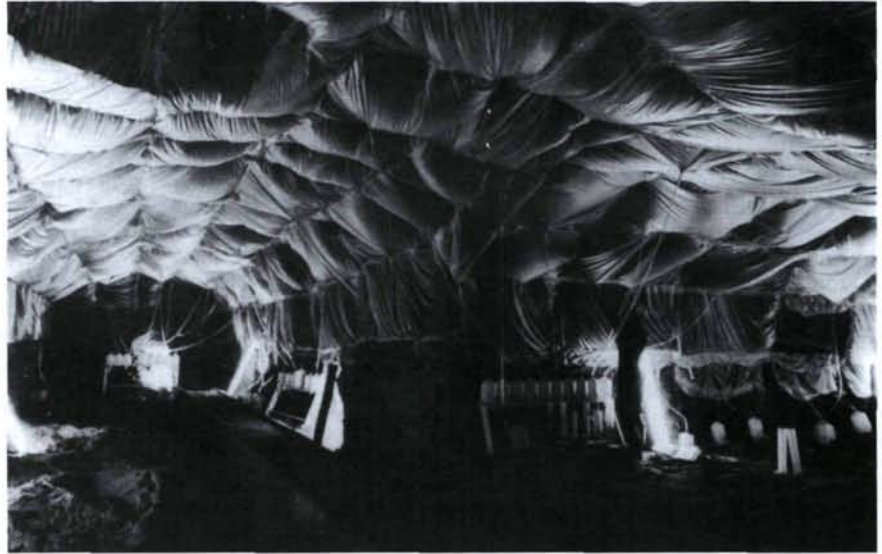
Dans le cadre des expériences faites pour déterminer le cheminement des eaux, les chercheurs ont recouvert les parois de cette galerie de feuilles de plastique pour recueillir des échantillons d'eau. (Photo: SKB)
