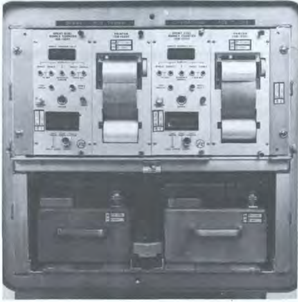
为不停堆换料的坎杜堆研制的乏燃料棒束计数器。(来源：加拿大原子能有限公司)
