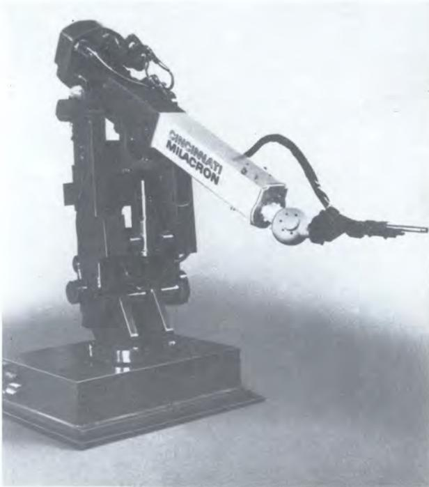
Робототехническая рука-манипулятор, используемая для выполнения работ по снятию установок с эксплуатации. (Предоставлено: Cincinnati Milacron),
