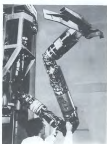
Робот ISIS, созданный компанией Хиспано Суиза, используется для проведения ремонтных работ на французском реакторе Чинон АЗ. (Источник: компания Хиспано Суиза.)
