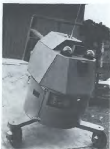
Этот управляемый по радио робот Ключе предназначен для наблюдения и транспортировки различного оборудования. (Источник: компания Цибермейшн инкорпорейтид.)
