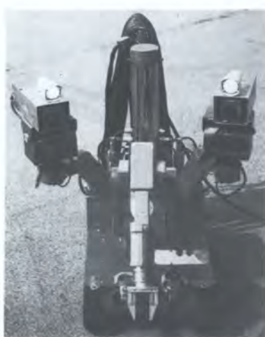
Герман — подвижный манипулятор на установке Y-12 в г. Окридж, штат Теннесси, используемый в качестве запасной системы для работ в токсичной и радиоактивной среде. (Источник: компания Мартин-Мариэтта энержи систем инкорпорейтид.)
