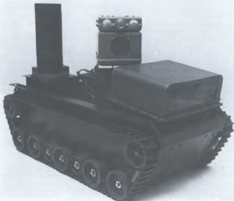
IRIS (промышленная система дистанционного контроля) — уникальный робот для работы в опасной для человека окружающей среде. (Источник: ИЭИ)
