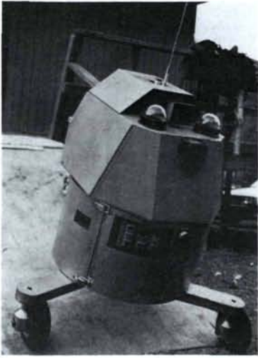
Ce robot radiocommandé appelé «Kluge» a été conçu pour la surveillance et pour le transport de divers types d'équipements. (Photo: Cybernation, Inc.)
