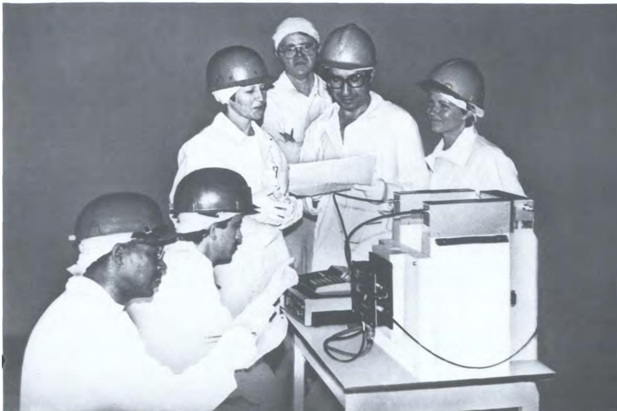
Сотрудники МАГАТЭ и новые инспекторы наблюдают сборку и проверку работоспособности уранового воротничкового счетчика нейтронов совпадения, применяемого для измерения содержания урана в свежем топливе легководных реакторов.
