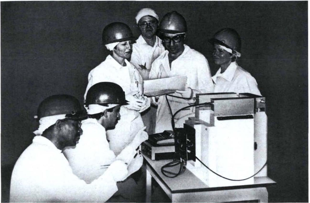
Membres du personnel de l'AIEA et inspecteurs novices en train de monter et d'essayer le fonctionnement du compteur annulaire de neutrons à coïncidence pour l'uranium. Ce matériel sert à mesurer la teneur en uranium du combustible neuf des réacteurs à eau légère.
