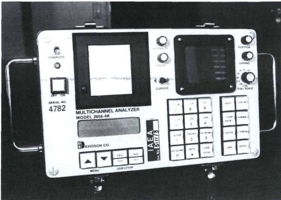
Figura 1. Minianalizador multicanal portátil. Los tres grupos de teclas (abajo a la izquierda, centro y derecha) permiten que el inspector regule interactivamente el instrumento en respuesta a las instrucciones que aparecen en la pantalla de cristal líquido (centro izquierda). Utilizando los controles situados a ambos lados de la pantalla de TRC (arriba a la derecha) se pueden proyectar los espectros en ésta y registrarse en una grabadora de cassettes (arriba a la izquierda).
