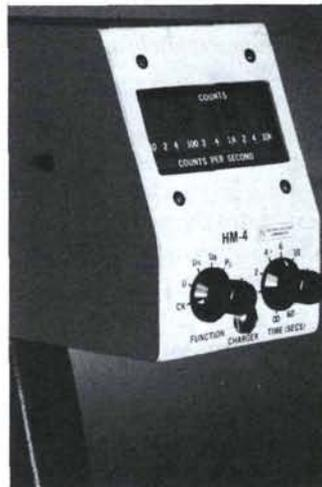
*Monitor manual para ensayos con rayos gamma*
