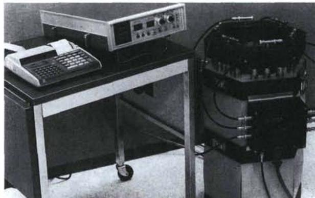
*Sistema de reducción de datos para el análisis isotópico del plutonio, con un analizador multicanal CICERO y un detector Ge*
