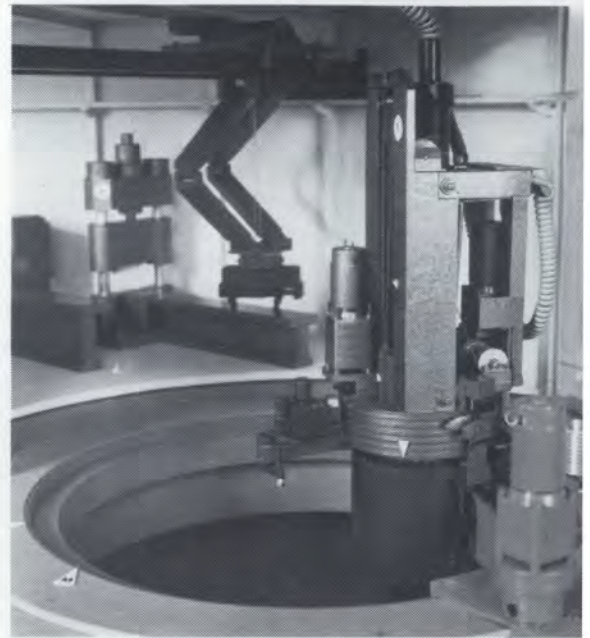
Рис. 21. Вид верхней части системы мощных манипуляторов, на котором видно отверстие вращающейся кольцевой фермы
