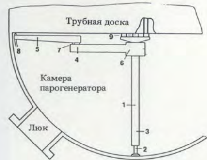
1 – стойка манипулятора с направляющим стержнем, 2 – пневматический цилиндр, 3 – мотор для вертикального перемещения, 4 – основной кронштейн, 5 – кронштейн зонда, 6 – мотор основного кронштейна, 7 – мотор кронштейна зонда, 8 – зонд, 9 – пальцевый замок
