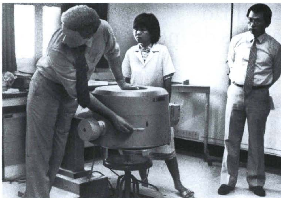
Utilizando una pequeña fuente de ^{99m}\text{Tc} , un experto del OIEA hace la demostración de un ensayo de estanqueidad del blindaje de una cámara gamma durante una sesión de trabajo en el seminario celebrado en Bangkok.
