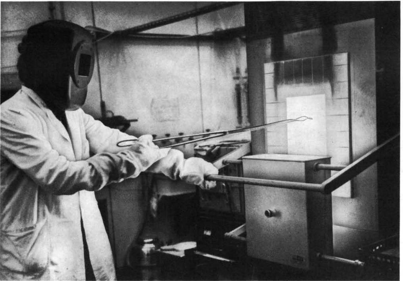
Fourneau utilisé pour la fabrication, à l'Institut de recherche nucléaire Hahn-Meitner, de verres au borosilicate et de céramiques de verre pour l'enrobage de produits de fission.
