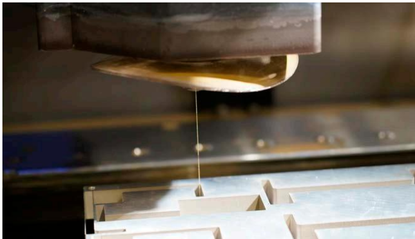
آلة تفرغ كهربائي تُغذى بالأسلاك من نوع Mitsubishi MP1200، تُستخدم لإنشاء سمات التعريف والمصادقة الفريدة للختم الخامل الجديد القابل للتحقق في الميدان.
