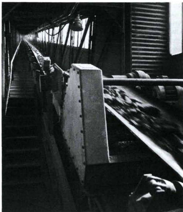
La bande transporteuse qui amène le minerai à l'usine de traitement de l'Ecarpière en Vendée (France).
