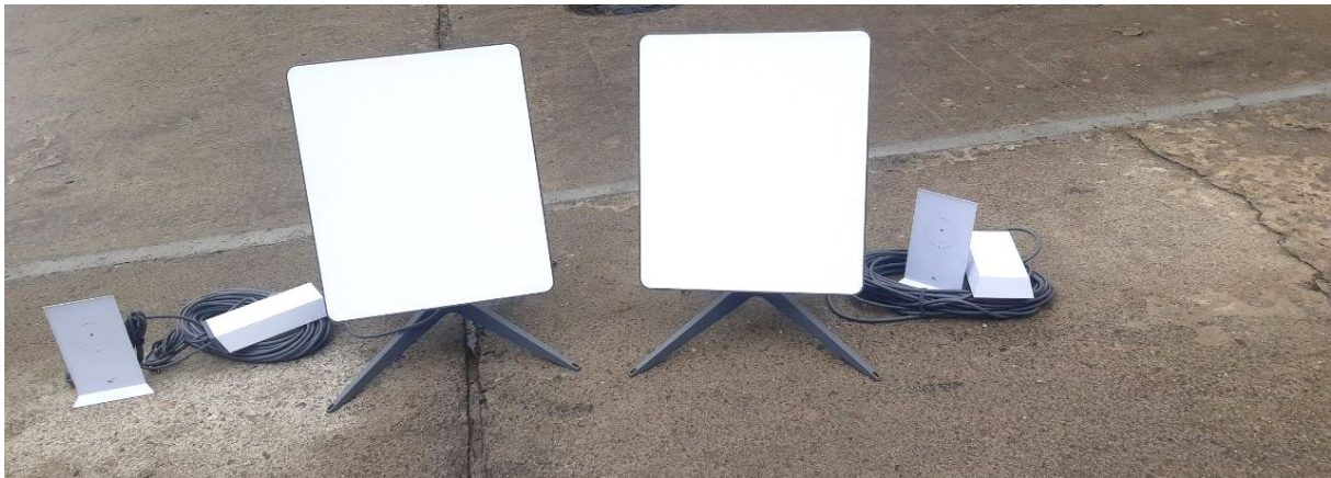
2023年10月5日交付给赫梅利尼茨基核电站的星链终端。该系统已于2023年10月24日启动并投入使用。欧洲联盟的预算外捐款被用于提供这一援助。（照片来源：赫梅利尼茨基核电站）
