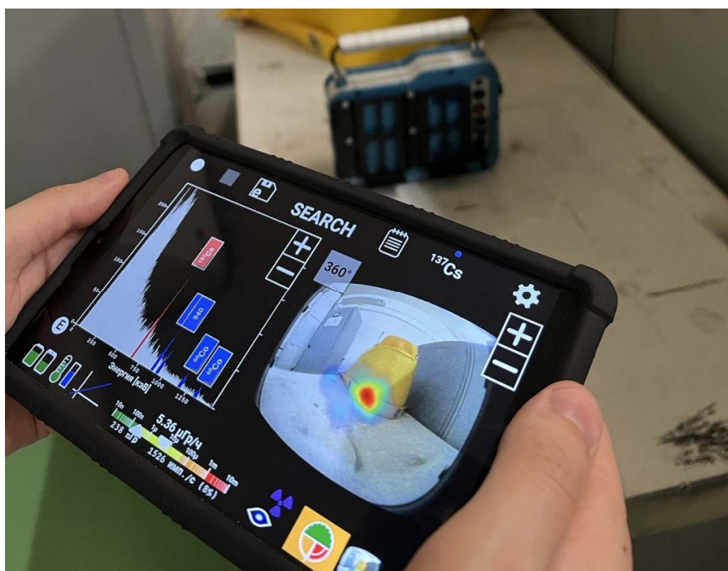
Espectrómetro de obtención de imágenes por rayos gamma en uso en la SUNPP. Este equipo fue adquirido por el Organismo con una contribución extrapresupuestaria del Reino Unido y entregado a la SUNPP el 26 de mayo de 2023. (Fotografía: SUNPP)
