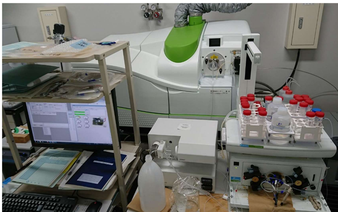
写真3 ICP-MS を使用した Sr-90 分析装置の外観
