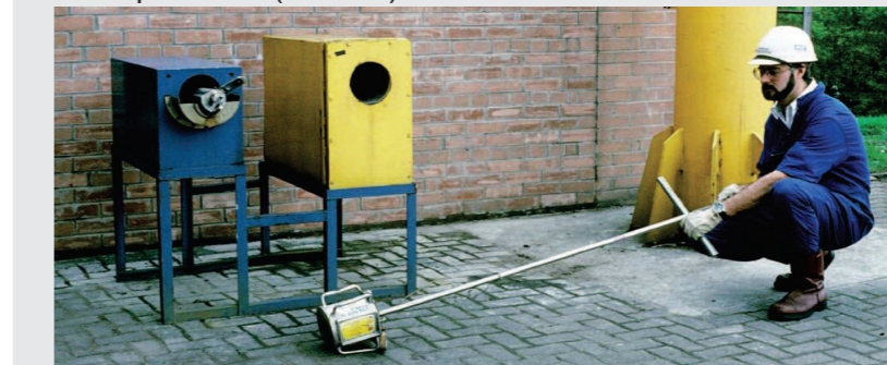
Cet opérateur doit suivre des procédures claires pour charger une source utilisée pour la diagraphie des sondages. Ces procédures peuvent établir qu'il doit empêcher l'accès à la zone pendant qu'il exécute l'opération, utiliser des outils de télémanipulation et terminer la tâche le plus rapidement possible.
