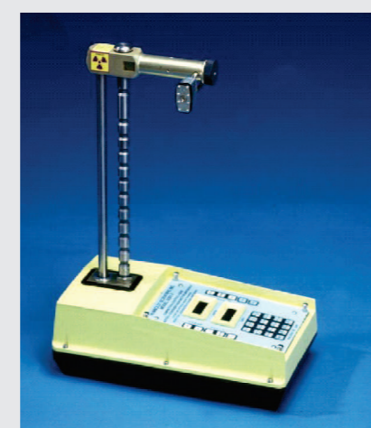
Jauge portable servant à mesurer le taux d'humidité et la densité, généralement du sol et de l'asphalte. Ces jauges contiennent des sources gamma et des sources neutroniques.
