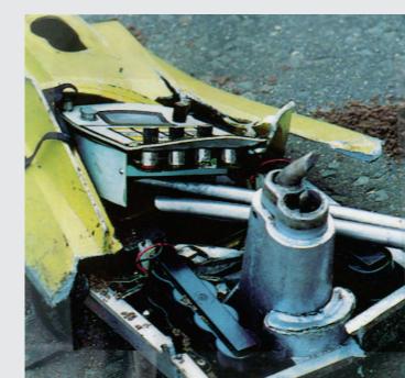
这名操作员必须遵照明确的程序装载测井源。程序可以说明：在他/她进行这项工作时，他/她必须防止进入工作区域，必须使用远距操作工具和尽快完成任务。
