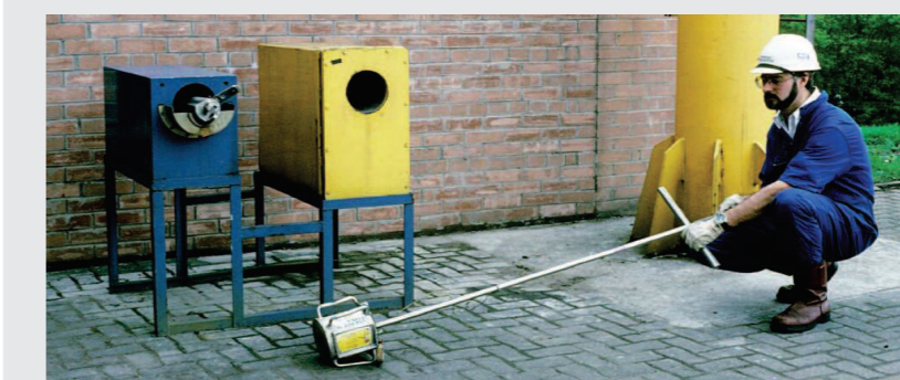
这名操作员必须遵照明确的程序装载测井源。程序可以说明：在他/她进行这项工作时，他/她必须防止进入工作区域，必须使用远距操作工具和尽快完成任务。
