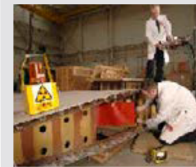
Arranjo para uma radiografia com raios-X.
