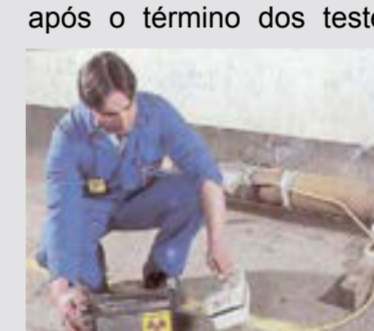
Operador verificando se a fonte radioativa retornou ao interior do irradiador.
