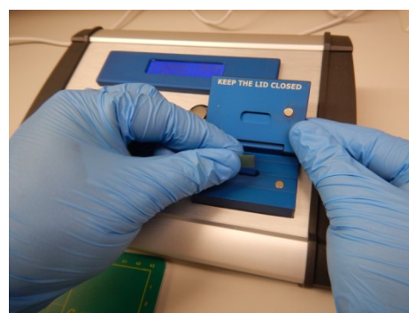
Figura 8. Inserción de la película Gafchromic en el DR4. La película debe ser manejada con guantes o pinzas
