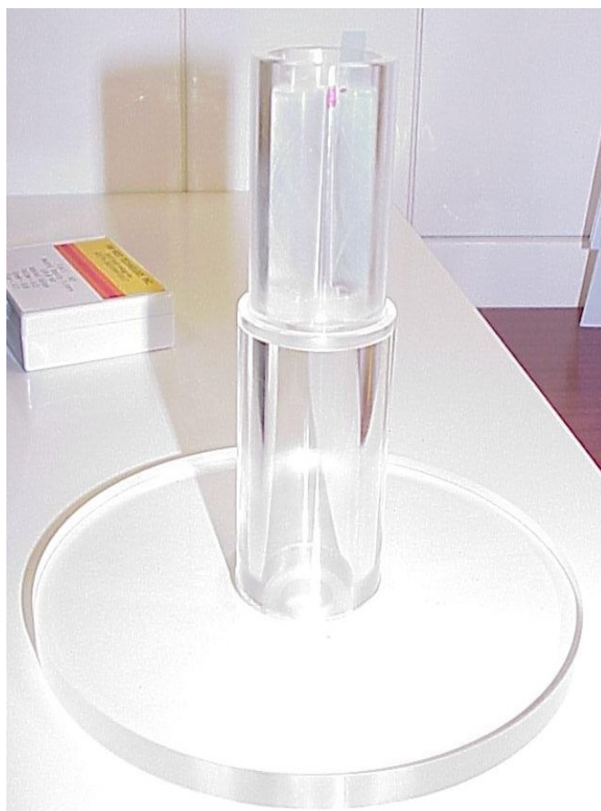
Figura 18. Un portadosímetro cilíndrico (como se muestra en la Fig. 15a) firmemente colocado sobre un soporte de PMMA para irradiación en un Gammacell. Este soporte consiste en una placa de base circular que encaja en la cámara de irradiación del Gammacell. En el centro de esta placa hay un tubo en el que se coloca el soporte del dosímetro. La altura de este tubo debe ser tal que, cuando el dispositivo este colocado en el Gammacell, el centro de los dosímetros coincida con el centro geométrico de la cámara de irradiación. Puede colocarse una marca en la base de la placa de tal manera que siempre sea colocada en la misma orientación en la cámara de irradiación del Gammacell. También puede colocarse una marca en el portadosímetro cilíndrico para reproducir la posición. Un dispositivo similar debe ser utilizado para un irradiador Hussman, de tal manera que los dosímetros (en el portadosímetro cilíndrico) puedan ser colocados consistentemente en la misma posición en el campo de radiación.
