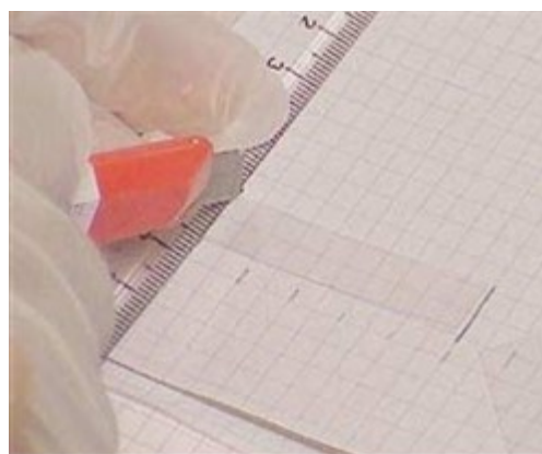
Figura 13. Un cuchillo afilado, una regla de plástico y una rejilla debajo de la película ayudan a cortarla convenientemente en longitudes deseables.
