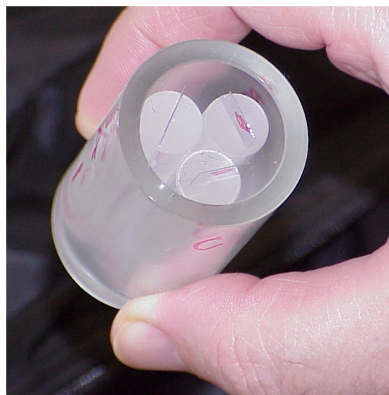
Figura 21. Tres portadosímetros con películas Gafchromic™ son colocados en el soporte cilíndrico para irradiación en un Gammacell. Note que los portadosímetros están colocados de tal manera que las películas queda paralela (tangencialmente) a la superficie curva del soporte cilíndrico. Para soportes planos (cuadrados, los portadosímetros deber ser colocados de tal manera que las películas queden paralelas a la cara mas larga del soporte.
