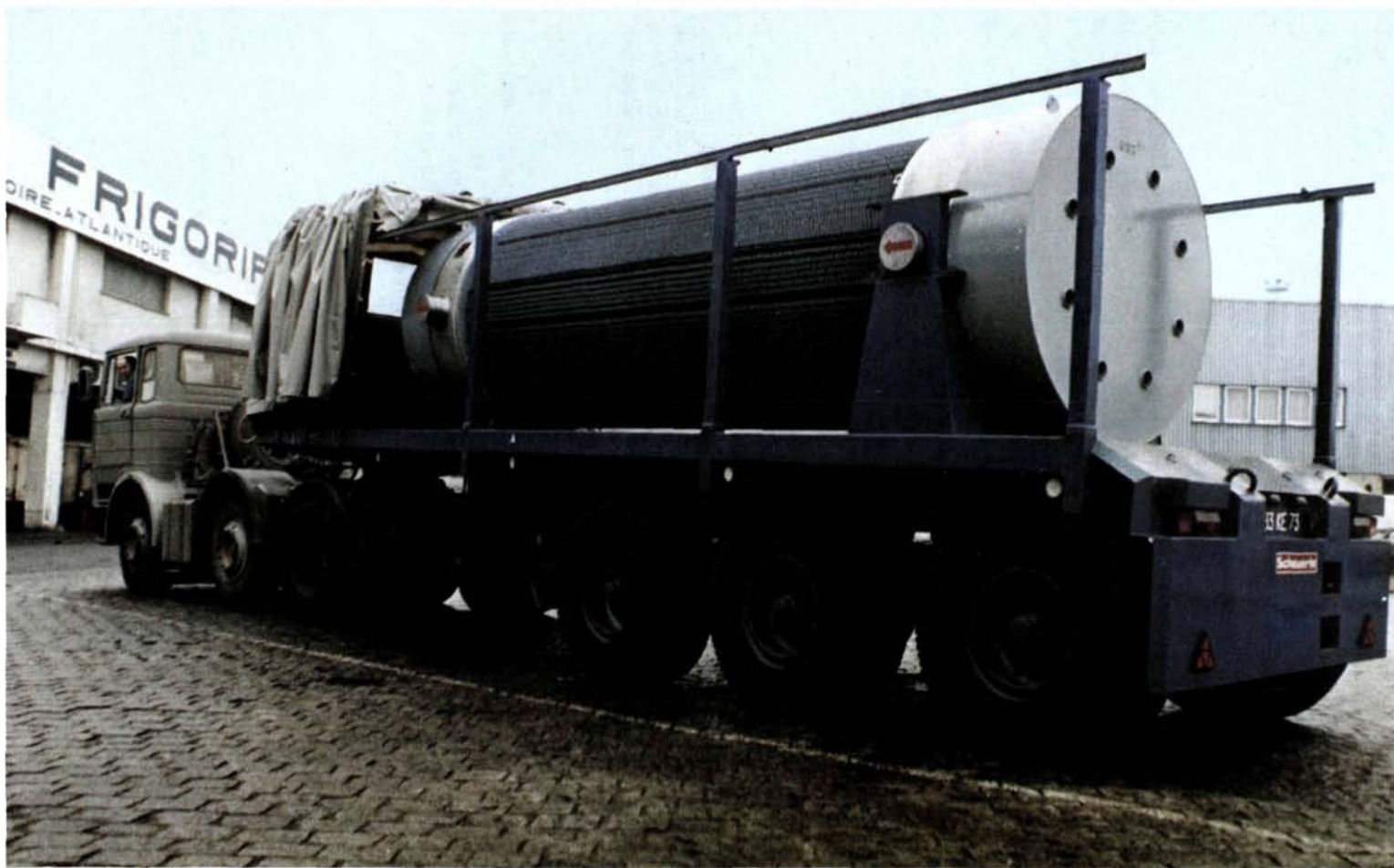
61 Figura 2. Cofre NTL 8 de 36 toneladas montado en un remolque.
