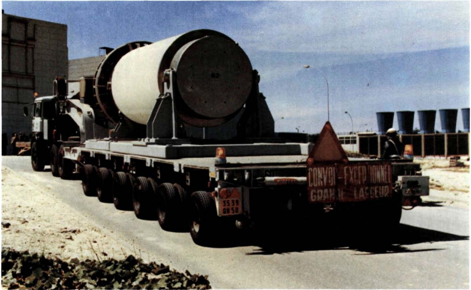
Figura 1. Cofre NTL 11 de 75 toneladas montado en un transporte de carretera.
