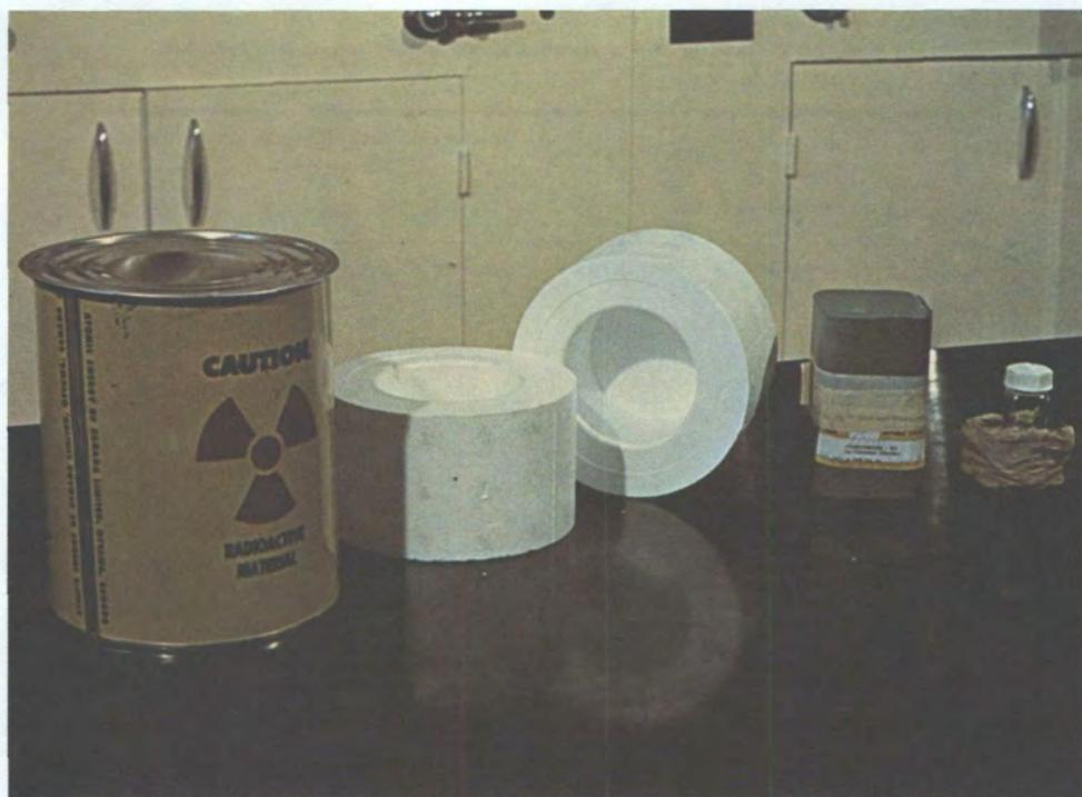
Рисунок 1а, 1б. Составные части упаковки типа А и упаковка в собранном виде.
