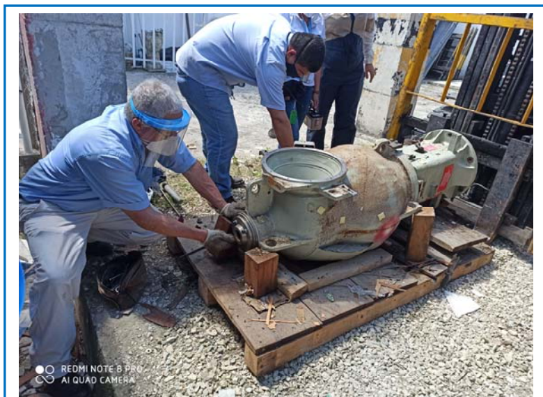
Специалисты демонтируют головку телетерапевтической установки, использовавшейся для лечения рака в Колумбии, в процессе ее подготовки к безопасному и
