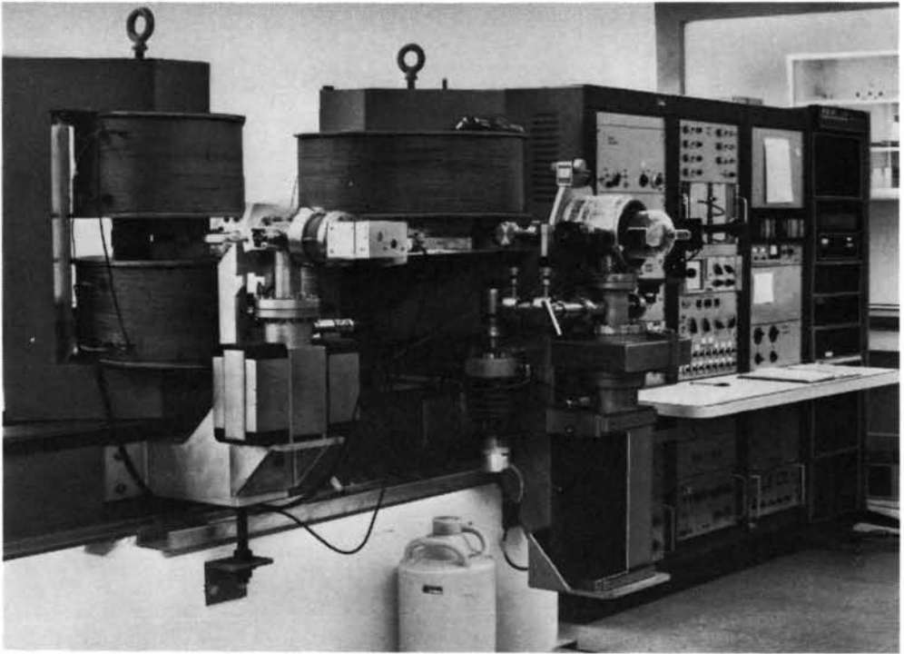
Ce spectromètre de masse à deux temps pour mesurer les impulsions a été spécialement conçu pour l'AIEA par le Laboratoire national d'Oak Ridge.
