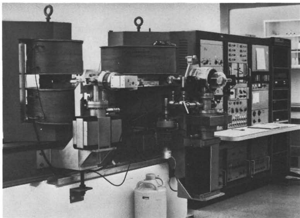
El espectrómetro de masas de dos etapas para contar impulsos ha sido diseñado especialmente para el OIEA por el Oak Ridge National Laboratory.
