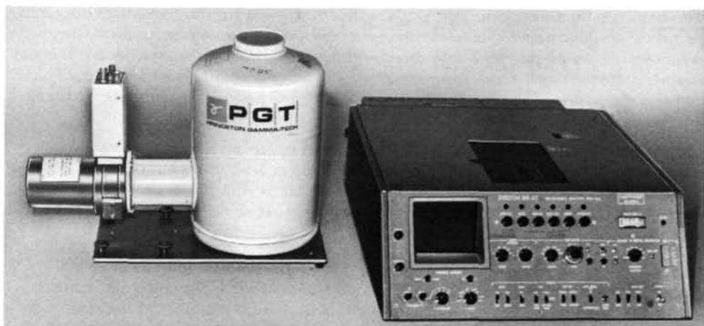
L'analyseur multi-canaux et détecteur au germanium Silena 27 servent à mesurer les produits de fission d'éléments combustibles irradiés.
