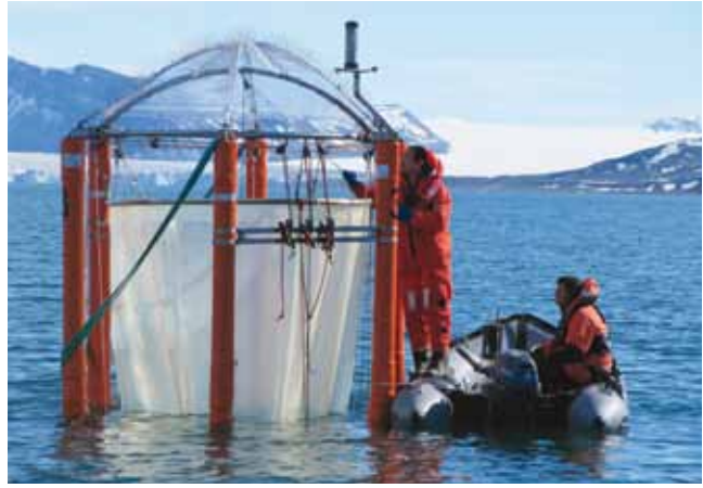
在斯瓦尔巴特群岛（Svalbard）外北冰洋高纬度区，欧洲海洋酸化研究计划的科研人员利用中尺度生态系统开展CO 2 加富实验。
