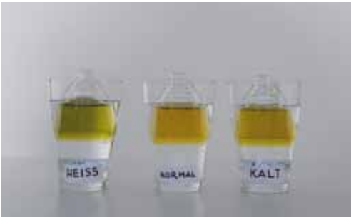
Abbildung 4: Die Grünfärbung zeigt: Das Wasser in der Flasche im heißen Bad hat bereits wieder \text{CO}_2 abgegeben.
