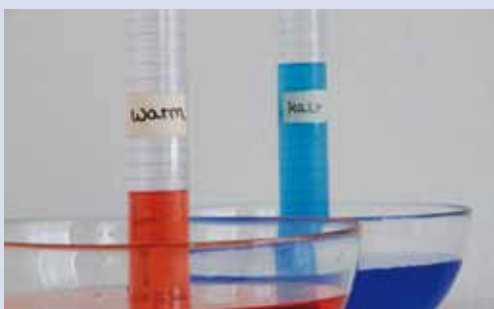
Abbildung 4: Die beiden Messzylinder im Vergleich. Zur besseren Unterscheidung ist das warme Wasser rot und das kalte Wasser blau eingefärbt.
