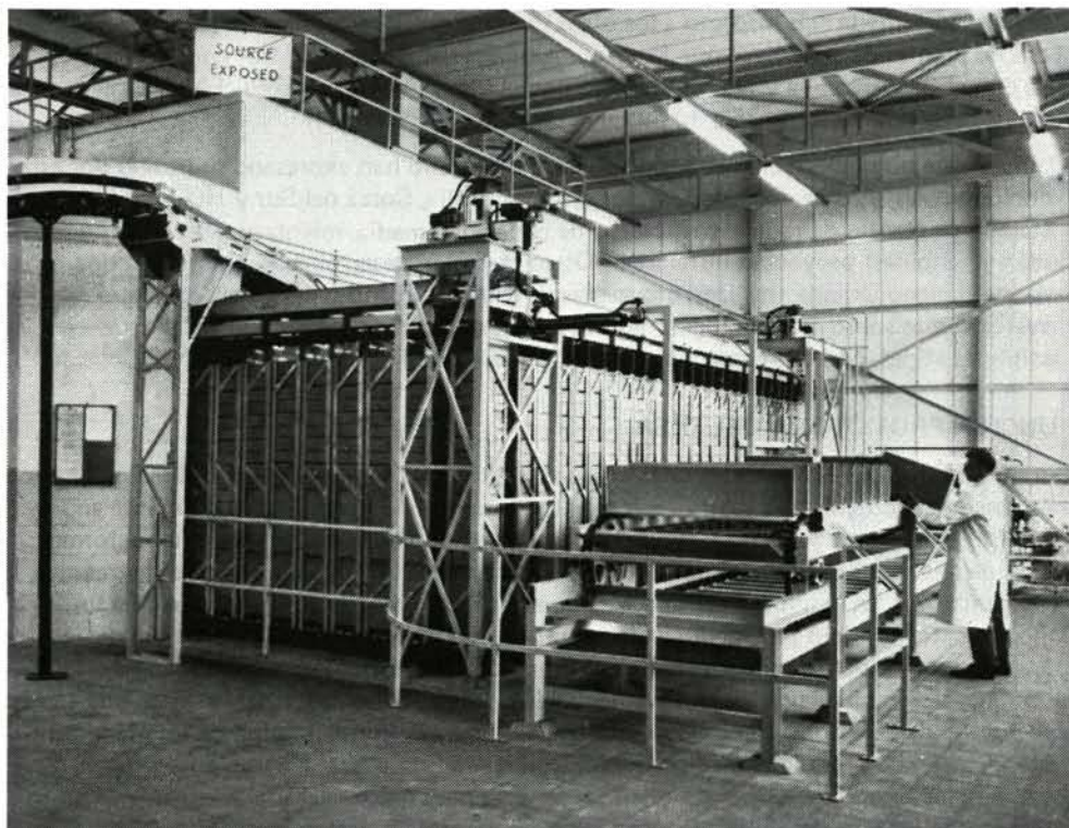
Planta de radioesterilización industrial de productos médicos en el Gillete Research and Development Laboratory, Reading, Berks., Reino Unido. Foto: Gillete.
