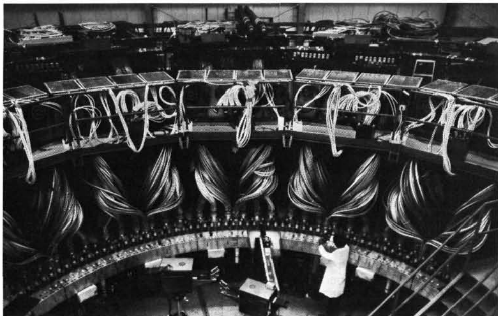
Scyllac, el dispositivo experimental de tipo toroidal y estricción azimutal del Laboratorio Científico de Los Alamos, Nuevo México (Estados Unidos de América). La cámara de descarga, de cuarzo, está situada dentro del anillo de aluminio; los innumerables cables son para conducir la corriente necesaria a fin de activar el calentamiento y los campos magnéticos de contención. Foto: Los Alamos Scientific Lab. (foto 1).
