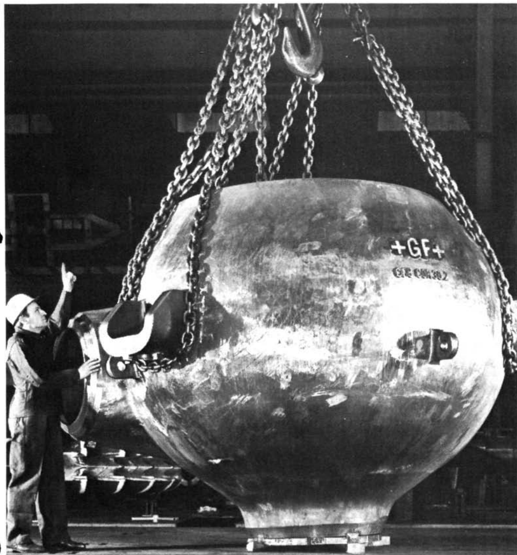
Instalación de la bomba con su difusor incorporado para el circuito de refrigeración de la central nuclear Beznau II, de Suiza. Su peso es de 37 toneladas. Foto: Georg Fischer AG.
