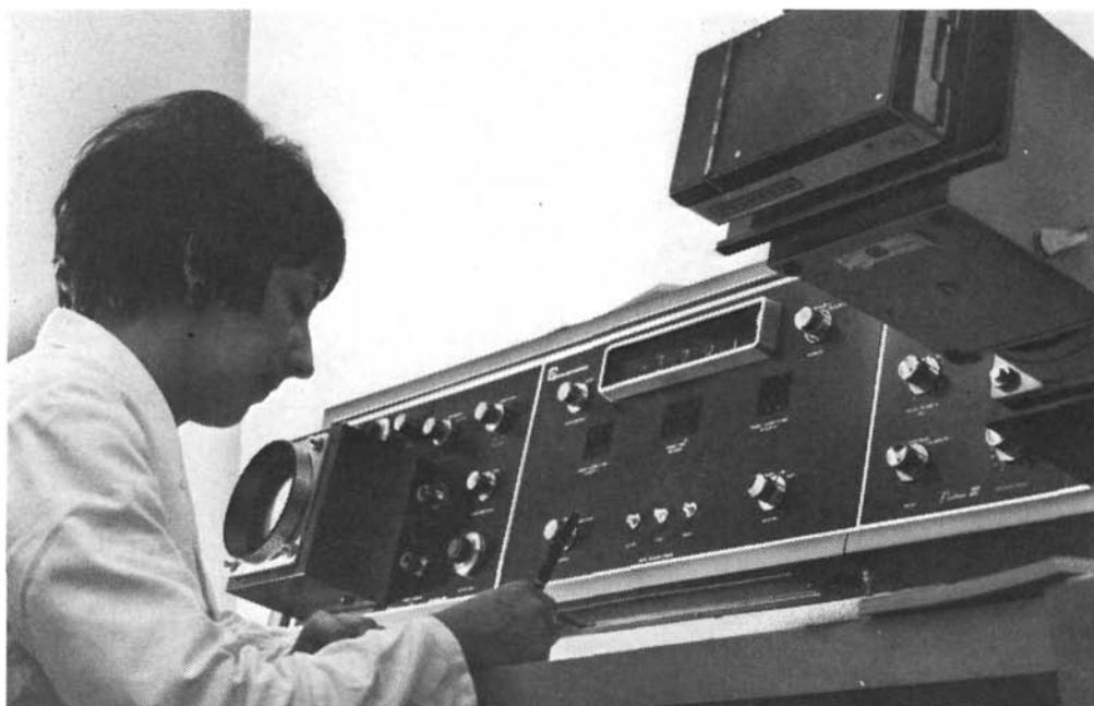
Pupitre de control de una cámara de centelleo para examinar la concentración de la radiactividad — OMS
