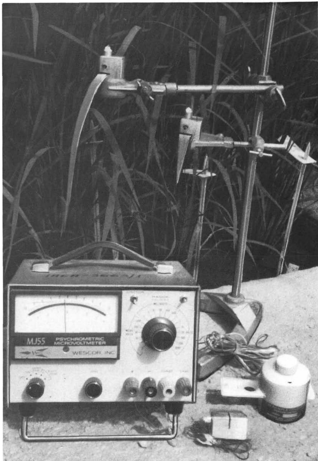
Un psicrómetro en acción sobre una hoja de planta y en el suelo.
