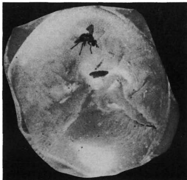
Surface supérieure du dôme de paraffine montrant une mouche Dacus en train de pondre. On emploie des dômes de paraffine minces pour obtenir des oeufs dans des conditions permettant les mesures
