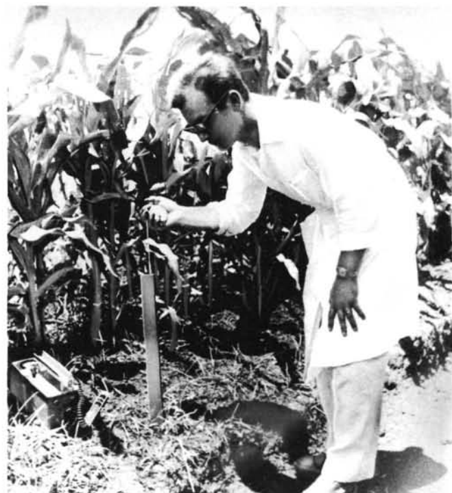
Científico de la Escuela de Agronomía de Piracicaba (Brasil), midiendo el grado de humedad del suelo con ayuda de radioisótopos
