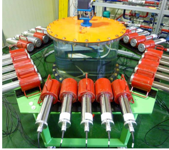
الشكل-٣- نظام صناعي للتصوير المقطعي الحاسوبي بالانبعاث الفوتوني المفرد - للعرض المرئي للمقتنيين الإشعاعيين الغاليوم-٦٨ والباريوم-١٣٧ المستقر الصادرين من المولدات.
