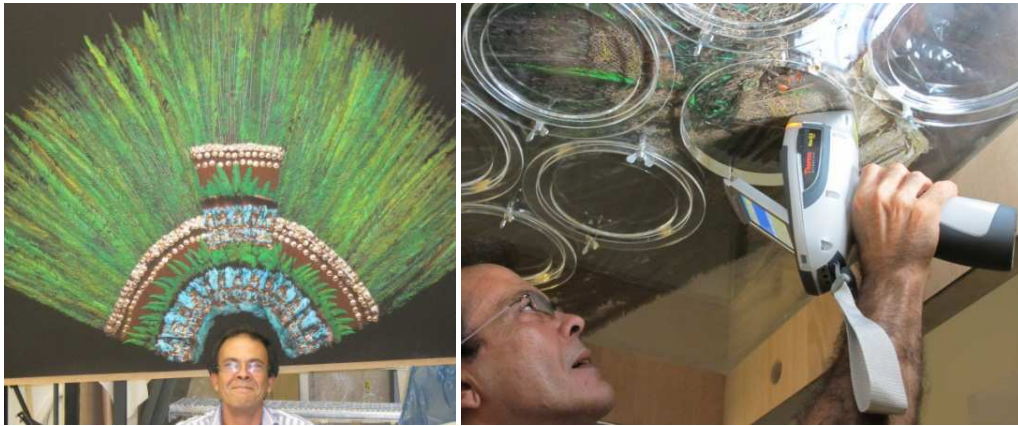
الشكل ٥ - استخدام مقياس محمول لطيف تالُق الأشعة السينية (إلى اليمين) لفحص غطاء الرأس مكسيكي يعود إلى القرن السادس عشر (إلى اليسار).
